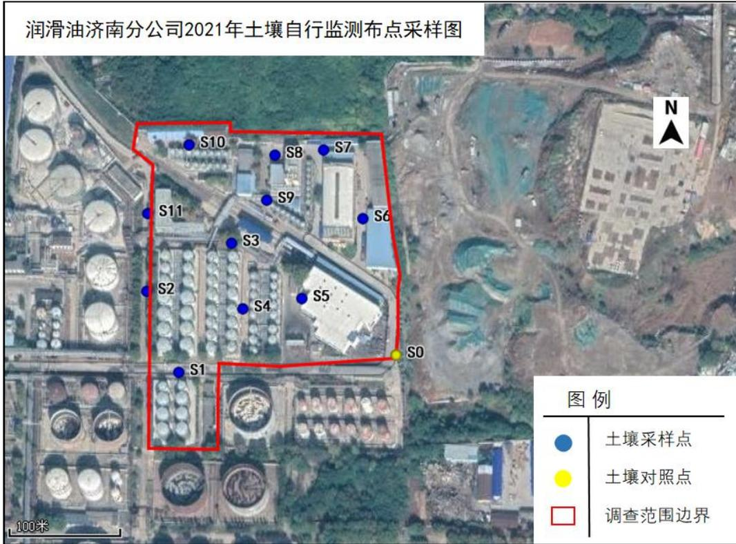
图 2-2 润滑油济南分公司 2021 年土壤自行监测布点采样图
